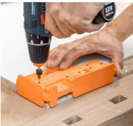
Puurimisšabloon LEGRABOXi põhja/ tagapaneeli jaoks
