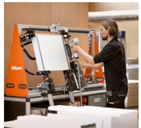
MERIVOBX-i kooste BOXFIX plusi ja naelapüssi abil
